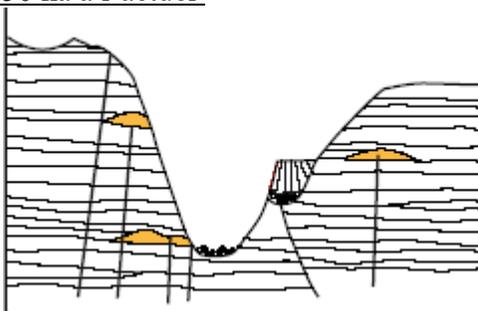
on a des coulées de basaltes suivies d'une érosion à l'origine d'alluvions puis une seconde coulées remplit la rivière et enfin on a une érosion à l'origine de nouvelles alluvions.
