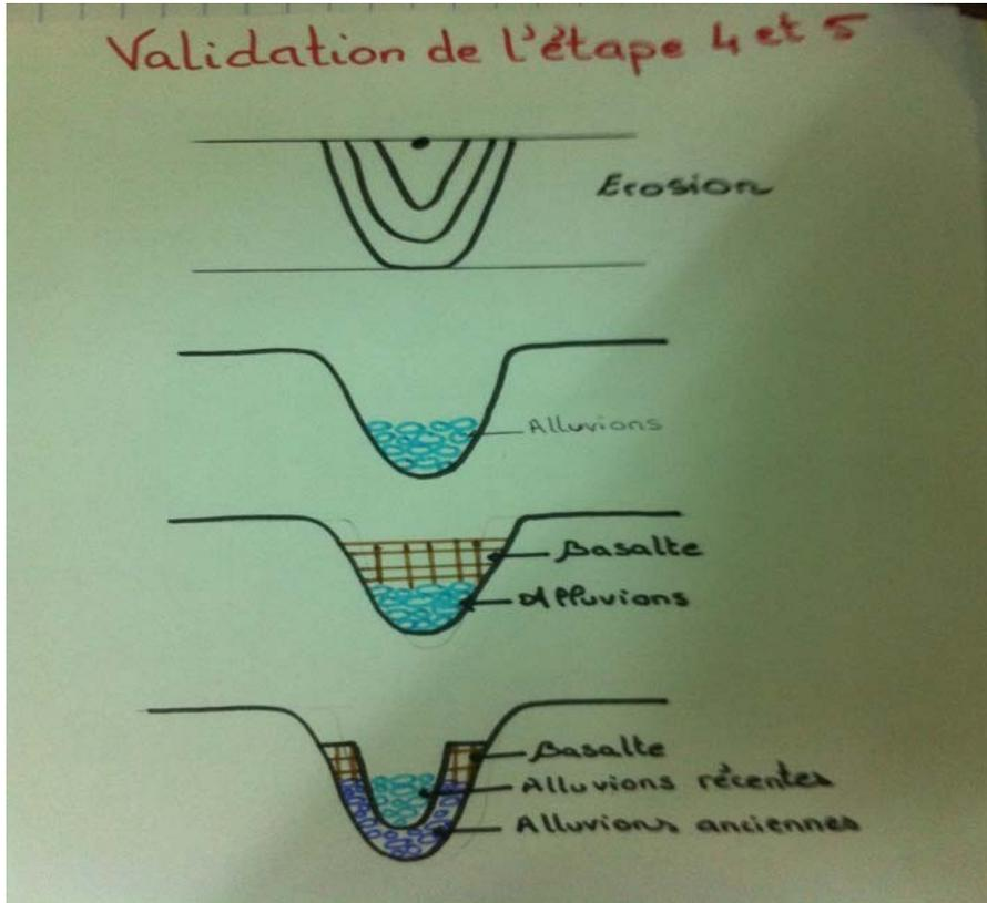
A partir des informations apportées grâce aux études réalisées aux arrêts 1,2,3 ; on a pu réaliser ce dessin constitué de différents schéma.
