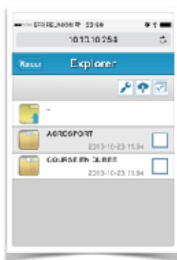
Et bien non ! L'ensemble des fonctions est vraiment pensé de façon simple et efficace. Il suffit de se connecter sur le WIFI de la Tripmate TITAN avec le mot de passe (11111111) et ensuite de taper l'adresse 10.10.10.254 sur son navigateur. On accède ensuite à la plateforme où il ne reste plus qu'à paramétrer les
